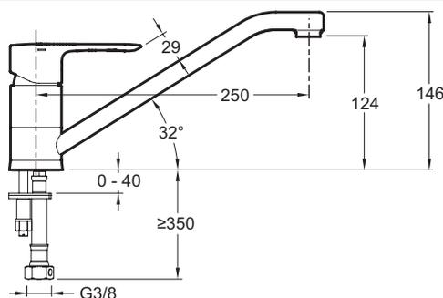
Description : Mitigeur évier, bec profilé. E16084-4. Collection : JULY. Poids : 1,2 kg. Normes et réglementations : NF : I - ECAU : E0 C2 A2 U3 - Ge3. Débit : 10 l/mn sous 3 bars. Mécanisme : Cartouche à disques céramique. Bec profilé orientable.
