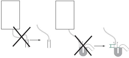
**⚠** Avant la première mise en route de l'appareil, il est impératif de remplir le siphon (13) de la chaudière avec de l'eau. Pour cela, verser environ 1/4 de litre d'eau par l'orifice d'évacuation des gaz brûlés avant de monter le dispositif d'évacuation ou dévisser le siphon placé sous la chaudière, le remplir d'eau et le remettre en place
