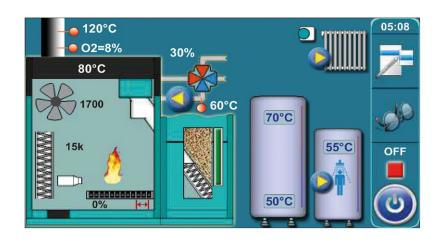
L'écran TOUCH SCREEN trouve tout son intérêt pour l'utilisateur car il lui permet de visualiser en direct le fonctionnement de la chaudière et de l'ensemble de l'installation de chauffage.
