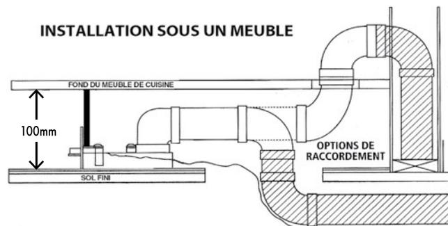
Le ramasse-miettes peut se raccorder soit avec du tube PVC comme ci-dessus soit avec le flexible fourni avec celui-ci.
