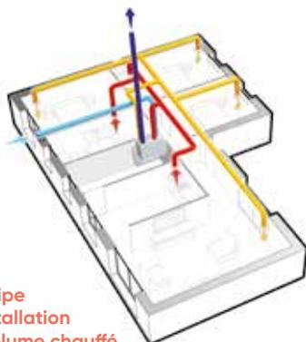
Principe d'installation en volume chauffé
