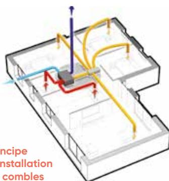
Principe d'installation en combles
