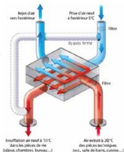
**En ÉTÉ** (avec by-pass), l'air neuf se refroidit au contact de l'air extrait : il pénètre dans la maison naturellement rafraîchi et évite de réchauffer le logement. La nuit, lorsque la température extérieure baisse, le by-pass vous permet d'insuffler l'air frais sans passer par l'échangeur.
