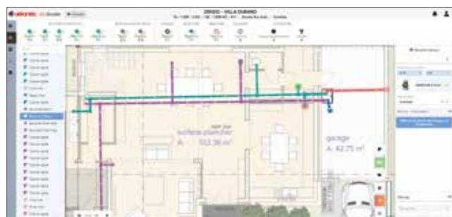
Exemple de conception d'une installation de ventilation double flux
