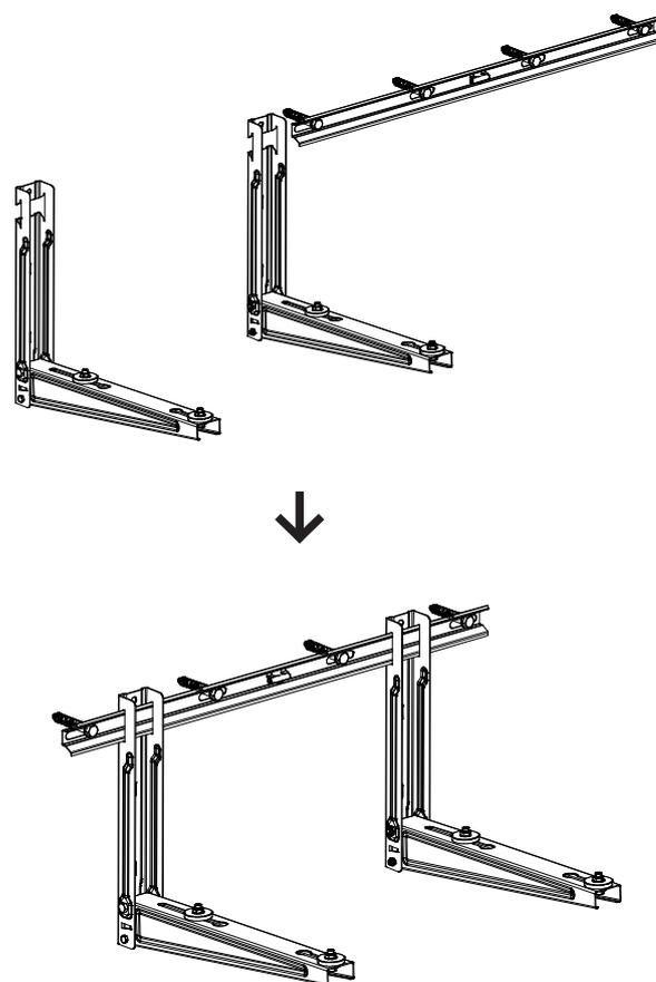
⑦ Enclencher les 2 bras verticaux et horizontaux dans la barre fixée au mur et posez l'unité extérieure.
