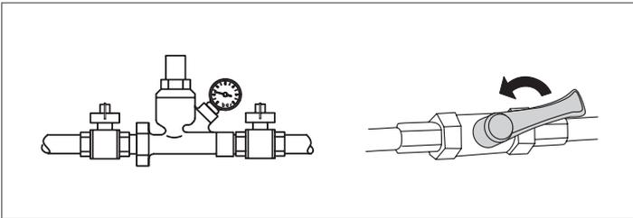
**⚠** Vidanger l'installation thermique s'il y a un risque de gel.
