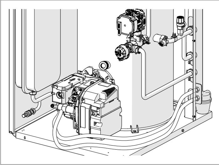
La connexion à l'aspiration de la pompe du fioul doit être effectuée directement sur le filtre (1) (accessoire), le tuyau de retour doit être relié sur le raccord prévu à cet effet (2). Vérifier que les raccordements réalisés sont étanches.
