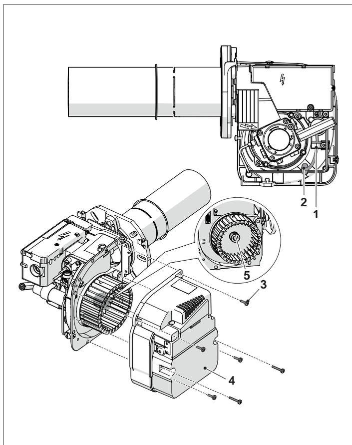
⚠ Lors de la repose du ventilateur, il est important de respecter la position (B) et de resserrer la vis (5).
