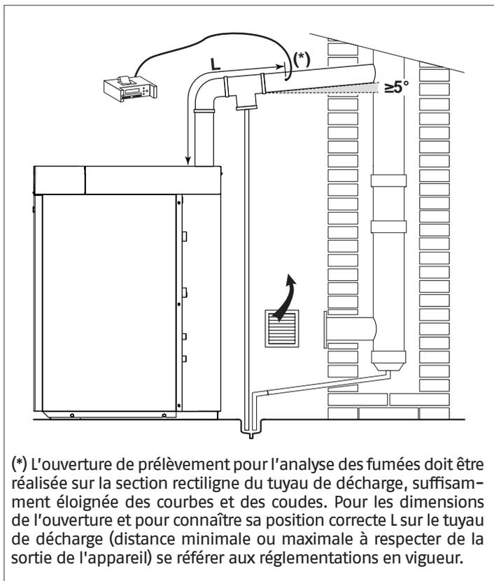
(\*) L'ouverture de prélèvement pour l'analyse des fumées doit être réalisée sur la section rectiligne du tuyau de décharge, suffisamment éloignée des courbes et des coudes. Pour les dimensions de l'ouverture et pour connaître sa position correcte L sur le tuyau de décharge (distance minimale ou maximale à respecter de la sortie de l'appareil) se référer aux réglementations en vigueur.
