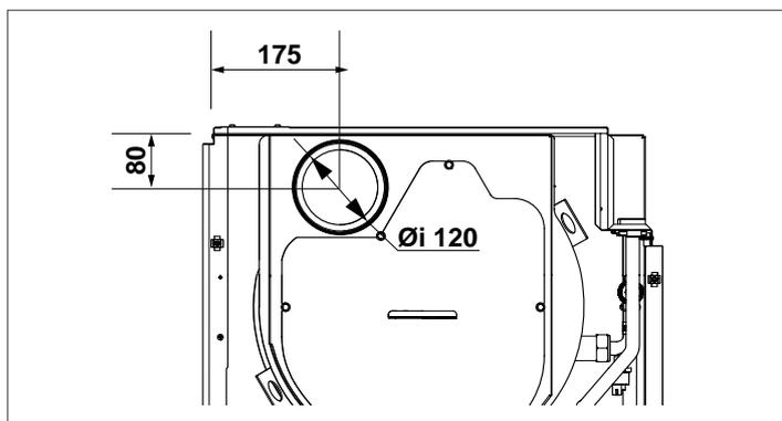
La chaudière **INSIEME EVOe 32 V – B100** aspire l'air comburant de la chaufferie à travers les orifices d'aération qui doivent être réalisés conformément aux normes techniques.
