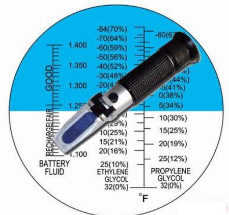
L'appareil est livré étalonné, toutefois pour refaire un réglage du point ZERO. Soulever le couvercle, recouvrir d'eau le prisme, refermer le couvercle. Ajuster ensuite la vis de correction afin de faire coïncider la limite bleu et blanche avec le point ZERO. Le réfractomètre doit être réglé à une température ambiante de 15 à 25°C.
